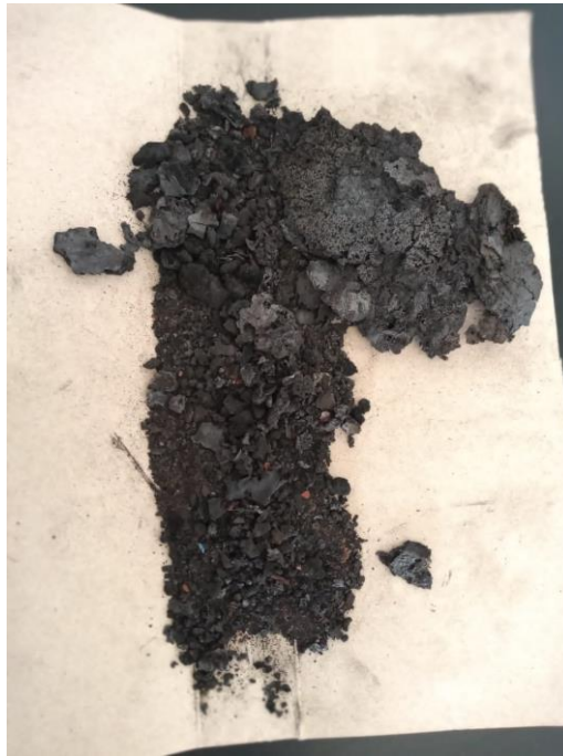
Figura 27. Residuos carbonizados resultantes de pruebas preliminares de pirólisis en el reactor de estudio empleando materia prima de poliestireno y polietileno.
