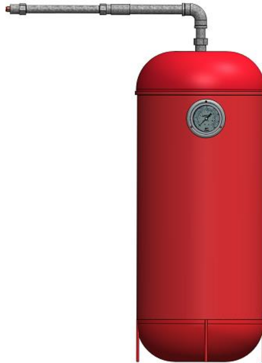
Figura 21. Vista frontal del reactor (cámara de pirólisis) objeto fin de la presente Tesis.
