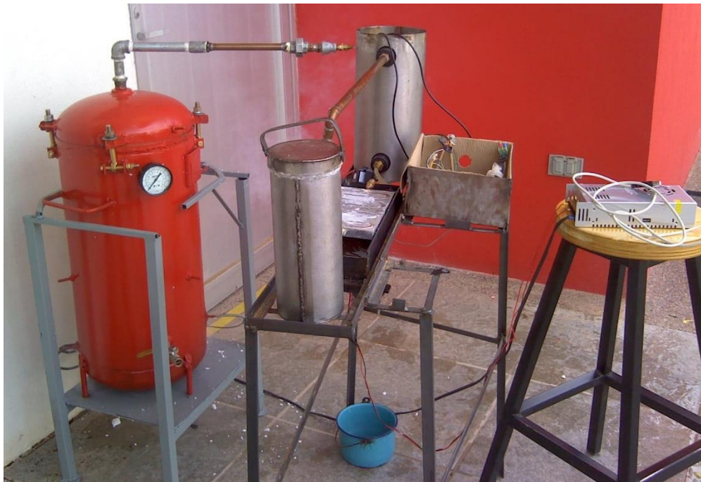
Figura 23. Vista completa del reactor de estudio con sistema de condensación integrado.
