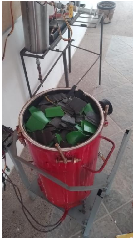
Figura 25. Representación de carga de materia prima (poliestireno y poletileno) en el reactor de estudio.
